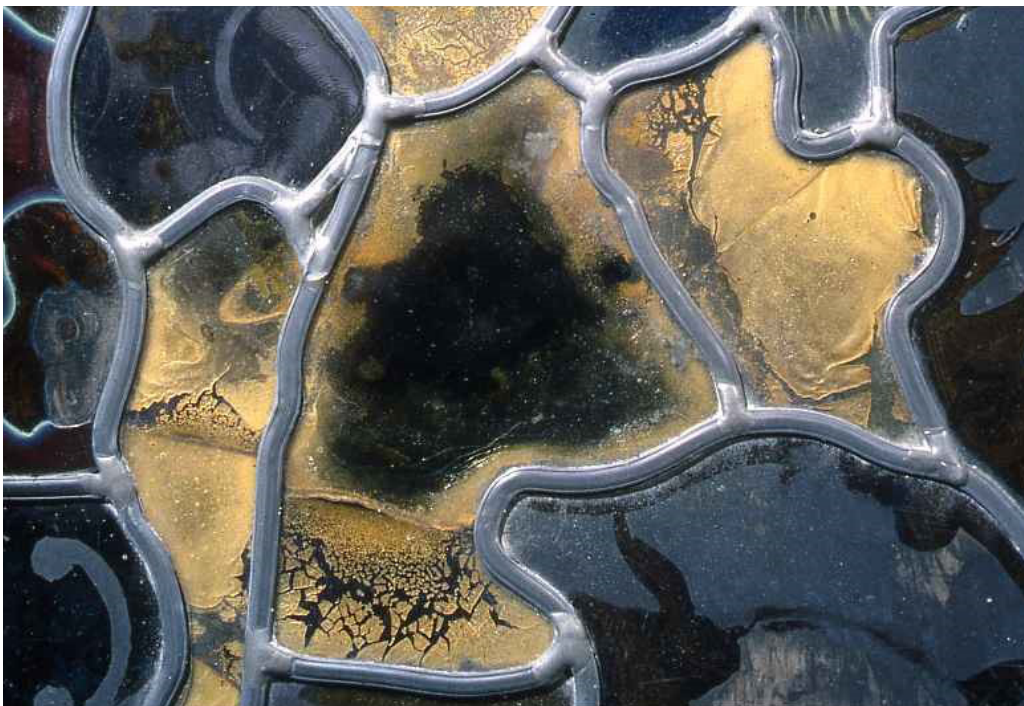
Zersetzung von Epoxy-Doublierungen von etwa 1970 an einem Glasgemälde des Kreuzgangs von Wettingen (© Stefan Trümpler)
